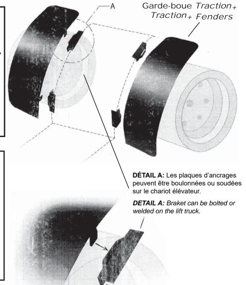
Lorsque *Traction* + n'est pas en utilisation, enlever les garde-boue en soulevant les supports hors des plaques d'ancrage. Entreposer dans un endroit sec.
