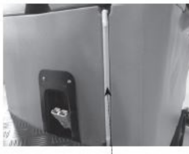
Gauge du niveau d'eau
